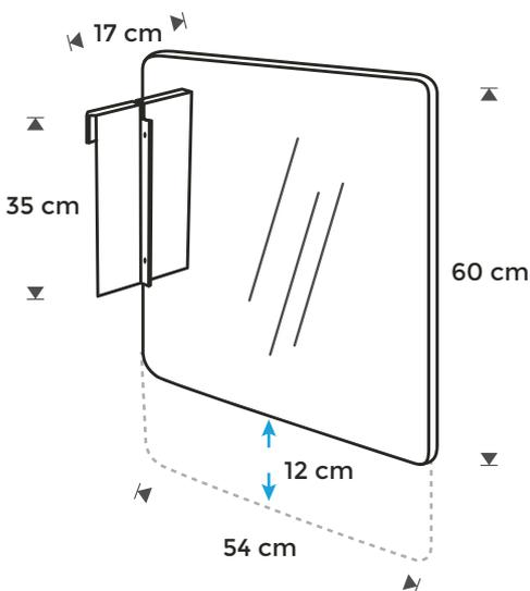
Pantalla protectora de cristal de 6mm de espesor y regulable en altura (2 posiciones). Pensada para una máxima adaptación a todo tipo de necesidades. Complemento perfecto para la gama de sofás Be Soft.
