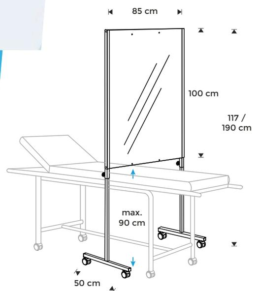
Pantalla protectora móvil y regulable en altura diseñada especialmente para dar solución a los centros de estética, podólogos, etc en los que sea necesario salvar camas o camillas. Medida interior de 80cm. Robusta estructura realizada en tubo de acero. Pantalla realizada en metacrilato de 1,5mm de espesor. Protección ante cualquier estornudo, previene la infección por transmisión de gotas. Ruedas con freno.
