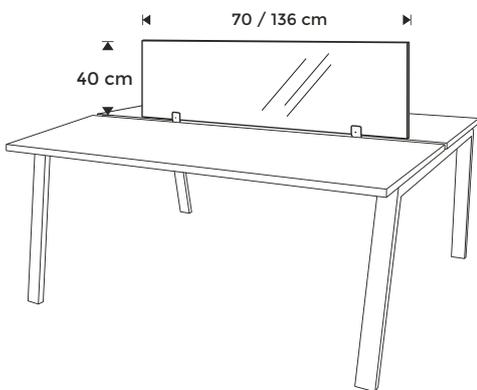
Paneles separadores de cristal templado de 10mm de espesor con acabado translúcido pensado para dar protección y privacidad en cada puesto de trabajo. Sistema de anclaje de fácil fijación.
